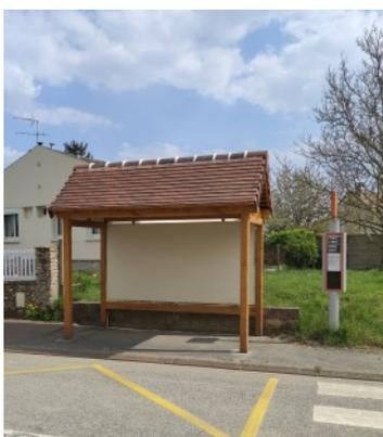
Deux nouveaux abribus ont été installés, l'un rue du Prieuré, l'autre au Bréau sans Nappe sur la D116. Ces abribus sont conformes aux normes handicapés et sont traversables par une personne en fauteuil roulant, d'où l'absence de parois latérales.
